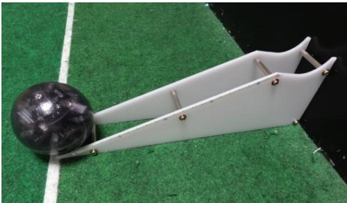
Рис. 1. Устройство для измерения мощности удара
