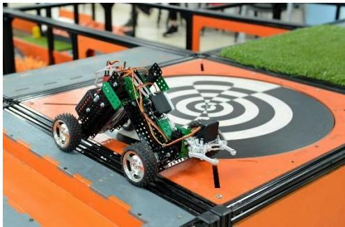
Крутящийся с переменной скоростью диск диаметром 650 мм, установленный в верхней грани ячейки (куба). Материал диска – фанера 10 мм. Поверхность диска покрыта виниловой пленкой.
