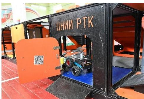
Дверь, открывающаяся на 90°на себя и от себя с ручкой типа «штанга». Габаритные размеры двери - 480x480 мм.
