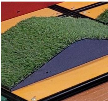
Испытание представляет собой двускатную наклонную 150, с габаритными размерами 420x690x160, на которой закреплена полоса искусственной травы или камни. Высота ворса 15 мм, габариты камней – произвольные, но высота камня не более 40 мм. Ширина боковых проемов по краям горки – 163 мм..
