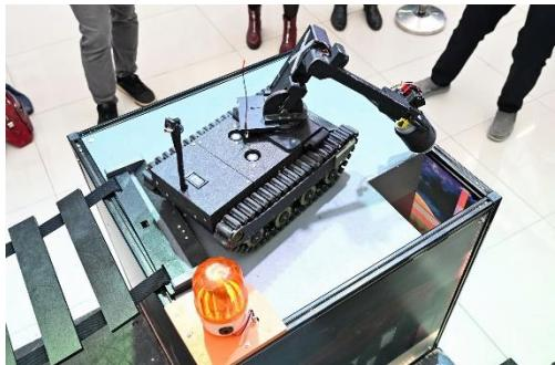
Конструкция в виде куба, на верхней плоскости размещены три контейнера, имитирующие радиоактивные обломки, а также шахта, куда их нужно сбросить. Каждый сброшенный контейнер уменьшает яркость подсветки, последний выключает ее. При въезде на ячейку сирена оповещает о начале отсчета одной минуты, за которую робот должен пройти испытание. По истечению времени подвесной мост, ведущий к испытанию, падает и отрезает ячейку.
