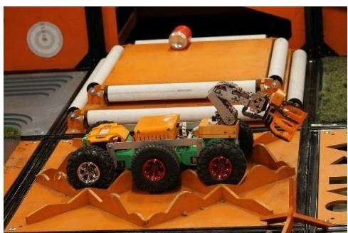
Плоская площадка с прикрепленными перпендикулярно к ней фанерными планками с волнообразной кромкой. Высота планок может колебаться от 10 до 80 мм.
