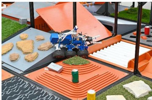
Конструкция состоит из нескольких слоев фанеры, уложенных параллельно друг на друга, которые формируют два возвышения. Высота первого возвышения (выступа) – 70 мм. Высота второго возвышения 50-60 мм.
