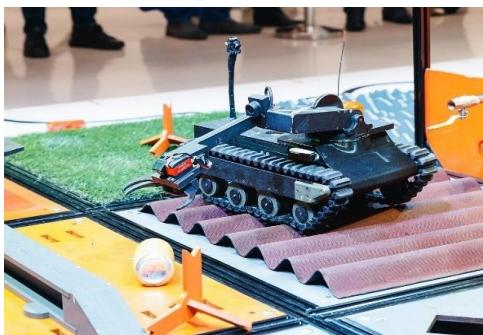
Отрезок волнистого кровельного материала (ондулина). Высота волны 38 мм, период волны 95 мм.
