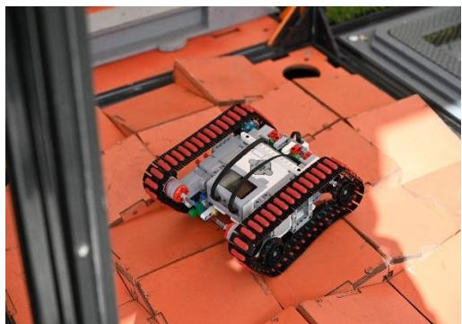
Ячейка заполнена 25-ю закрытыми коробами (рампами). Верхняя грань каждого короба имеет наклон в 15°. Рампы составлены таким образом, что их верхние поверхности образуют по высоте неравномерную структуру. Рампы разной высоты с перепадом высот 50 мм.
