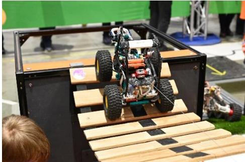
Подвесной мост собран из деревянных планок, закрепленных на стропах. Промежуток между планками составляет 15-20 мм. Длина моста варьируется, ширина 400 мм.
