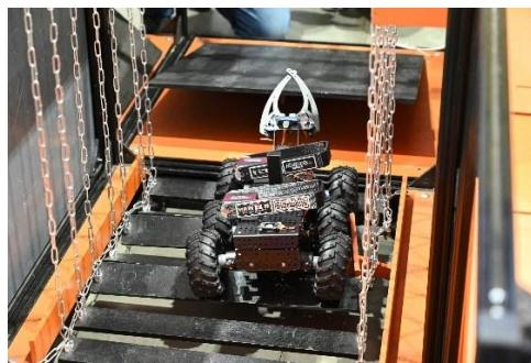
Мост набран из деревянных планок, подвешенных на цепях к верхним ребрам куба. Ширина моста - 500 мм, планки - 65 мм, расстояние между планками - 35 мм. Все планки моста попарно соединены цепочкой, раздвигаются между собой на ширину не более 65 мм. Высота моста относительно пола ячейки - 80 мм.
