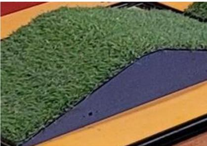
Испытание представляет собой двускатную наклонную  $15^\circ$ , с габаритными размерами 420x690x160, на которой закреплена полоса искусственной травы или камни. Высота ворса 15 мм, габариты камней – произвольные, но высота камня не более 40 мм. Ширина боковых проемов по краям горки – 163 мм.
