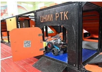
Дверь, открывающаяся на 90° на себя и от себя с ручкой типа «штанга». Габаритные размеры двери - 480x480 мм. Высота ручки двери над полом – 220 мм, толщина – 8 мм, длинна – 110 мм. Может размещаться в стене дома.
