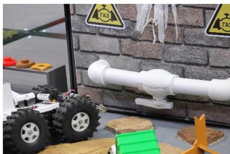
На стене дома расположена «газовая» труба с одним большим вентиляем. Над трубой находится отверстие из которого выходит «газ» о чем свидетельствуют бумажные полоски (работает вентилятор). С начала попытки на доме работает сигнализация, указывающая на утечку (гирлянда на крыше мигает красным). Задача участника перекрыть вентиль.
