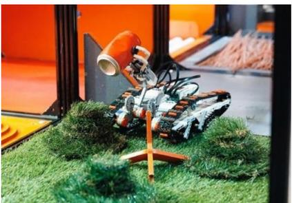
Площадка, покрытая искусственной травой из полипропилена с высотой ворса 18 мм. На ней произвольным образом расположены наборные конструкции из искусственной травы, имитирующие деревья. Максимальный диаметр «деревя» 150 мм, максимальная высота «деревя» 110 мм.
