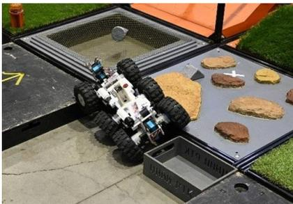
Плоская площадка, на которой закреплены камни с острыми углами и резкими перепадами по высоте от 0 до 60 мм.
