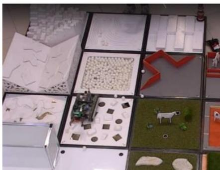
Набор испытаний, моделирующих пересеченную местность арктической пустыни. Череда препятствий состоит как из дублирующих с основного полигона Кубка РТК ячеек, так и из новых испытаний на проходимость.
