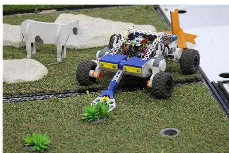
Робот с помощью манипулятора должен вытащить «сорняки»\*\* из лунок ячейки «Простая посадка» (лунки расположены по прямой линии), в которых они находятся. Дополнительно доставлять сорняки nowhere не требуется.
