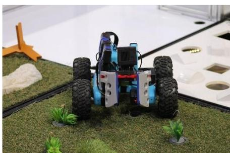
Робот с помощью манипулятора должен вытащить «редиски»\*\* из лунок ячейки «Сложная посадка» (лунки расположены по кругу), в которых они находятся. «Редиску» необходимо доставить на ячейку «Склад»\*.
