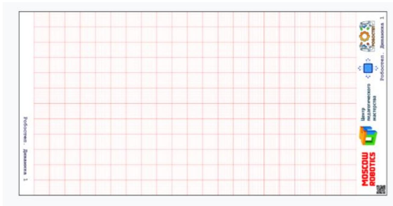
Размер поля 120\*240 см. (см. Макет). Тренировочное поле можно выполнить самостоятельно. На белый баннер наносится сетка, невидимая для датчиков. Размер ячейки 10\*10 см. Препятствие и разметка на поле создаются из подручного материала: коробок, изоленты, стенок лабиринта.
