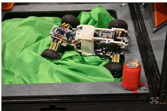
В ячейку уложен полиэстеровый мешок, наполненный до половины полистироловыми шариками фракцией 4-6 мм.
