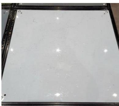
Скользкая поверхность (фторопластовая пластина). Для большей скользкости на поверхность может наноситься универсальная смазка WD-40 или ее аналог.
