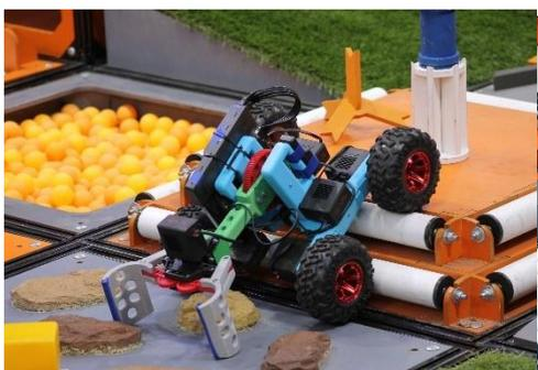
Ступенчатая пирамида, состоящая из двух уровней. Параллельно длинным ребрам каждого уровня закреплены вращающиеся трубы. Общая высота – до 140 мм. Высота ступени - 60 мм.
