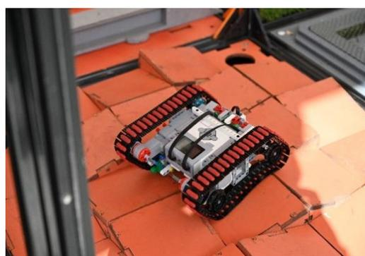
Ячейка заполнена 25-ю закрытыми коробами (рампами). Верхняя грань каждого короба имеет наклон в  $15^\circ$ . Рампы составлены таким образом, что их верхние поверхности образуют по высоте неравномерную структуру. Рампы разной высоты с перепадом высот 50 мм.
