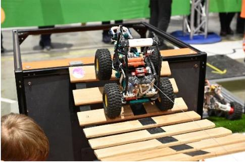
Подвесной мост собран из деревянных планок, закрепленных на стропях. Промежуток между планками составляет 15-20 мм. Длина моста варьируется, ширина 300 или 400 мм. На мосту может быть нанесена линия контрастного цвета шириной 40 мм для автономного прохождения
