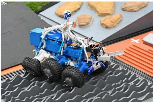
Плоская площадка с прикрепленными к ней перпендикулярно фанерными планками с волнообразной кромкой. Планки расположены параллельно друг другу. Высота может колебаться от 10 до 80 мм.
