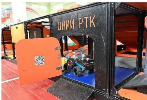
Дверь, открывающаяся на 90° на себя и от себя с ручкой типа «штанга». Габаритные размеры двери - 480x480 мм. Высота ручки двери над полом – 220 мм, толщина – 8 мм, длина – 110 мм. Испытание размещается в одном кубе, в котором может находиться дополнительное испытание.
