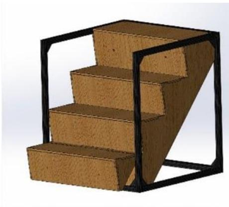
Лестница с габаритными размерами ширина 740 мм, высота ступени 185 мм, глубина ступени 254 мм. Подступенок (вертикальная часть ступени) имеет небольшой обратный наклон.
