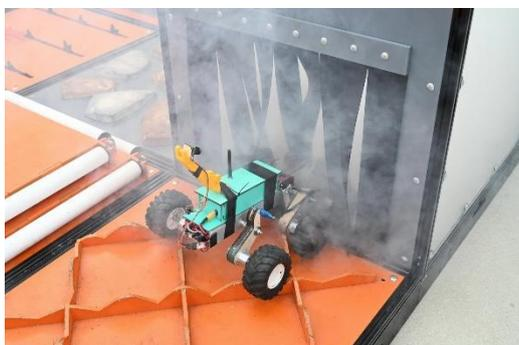
2-3 куба с сильным задымлением, создаваемым дыммашиной. Стенки выполнены из прозрачного оргстекла. К полу кубов в произвольном порядке прикручены шипы и светильники из оргстекла, которые можно включить роботом при помощи кнопки на полигоне. Секции имеют въезды - арочные проемы 500x500, занавешенные полосками резины.
