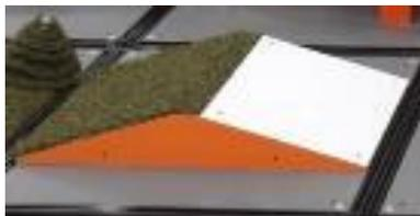
Испытание представляет собой двускатную наклонную 150, с габаритными размерами 420x690x160, на которой закреплена полоса искусственной травы или камни. Высота ворса 15 мм, габариты камней – произвольные, но высота камня не более 40 мм. Ширина боковых проемов по краям горки – 163 мм.
