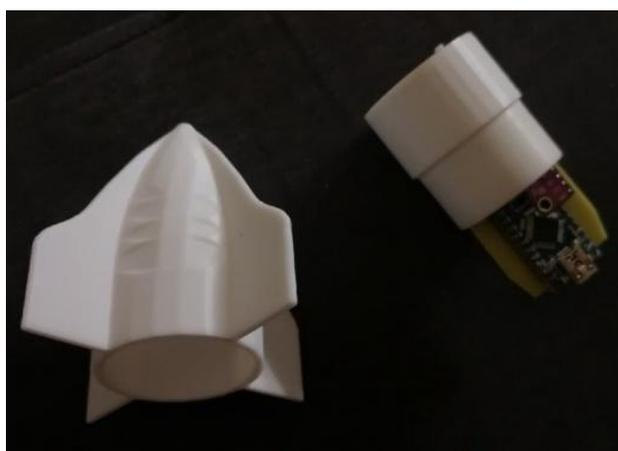
Рисунок 3 Детали обтекателя, отпечатанные на 3-d –принтере
