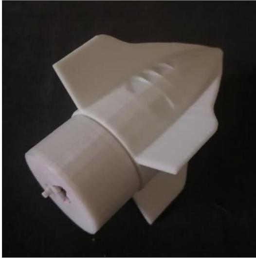
Рисунок 4 Обтекатель, отпечатанный на 3-d –принтере, в собранном виде
