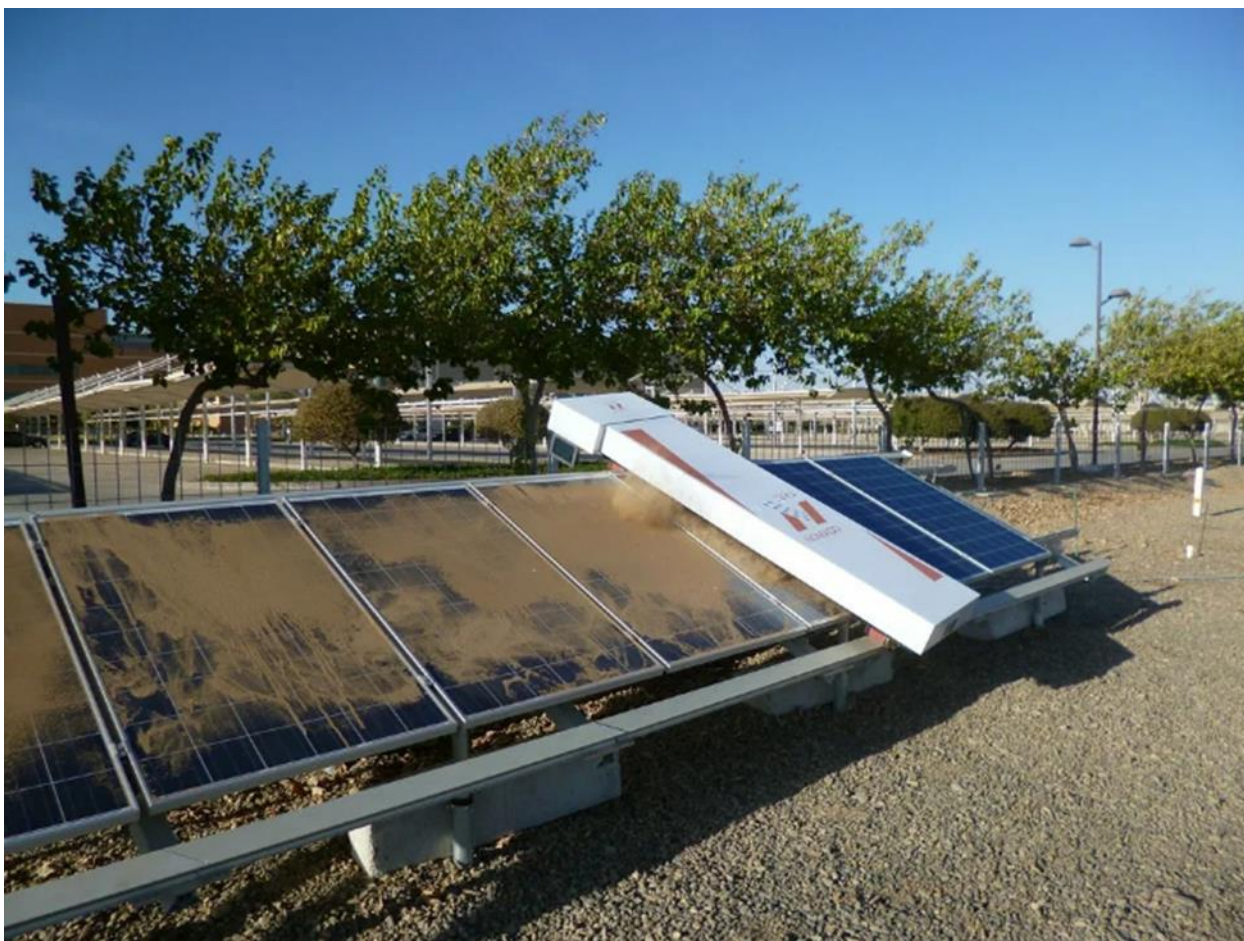
Рисунок 3. Загрязнение песком после бури.
