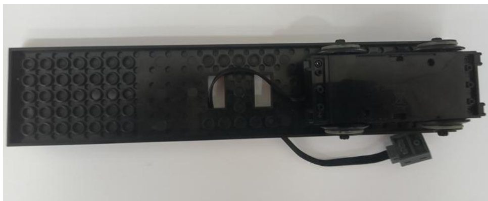
Лего-платформа и лего-мотор для поезда:
