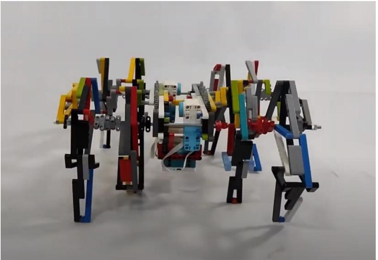
Робот, созданный на базе образовательного набора LEGO® Education SPIKE™ Prime. Робот оснащен четырьмя большими моторами, для приведения в движение конечностей или других функциональных частей. Ноги робота выполнены в технике, характерной для линейки Трансформеров, с использованием типичных для LEGO® соединений и элементов. Конструкция ног позволяет предположить наличие механизма шагания или другой формы мобильности.
