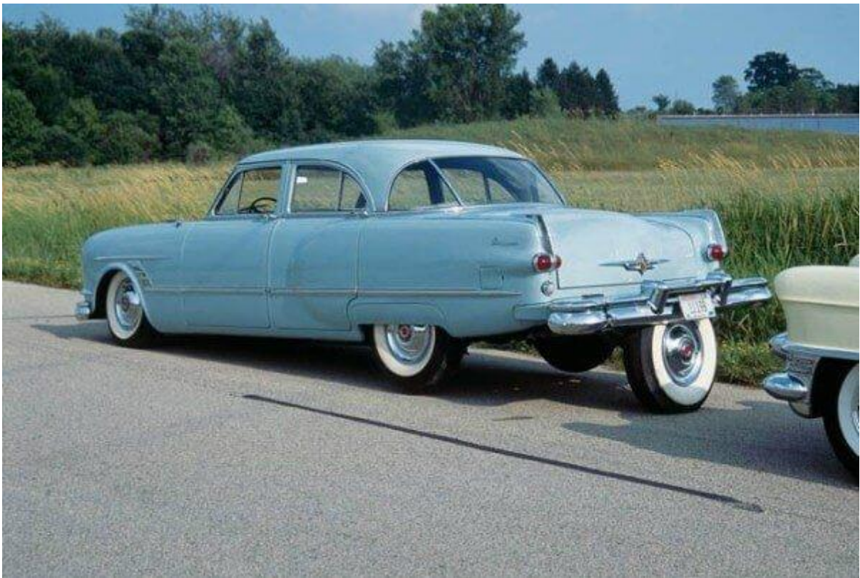
Рис. 2. Система парковки с пятым колесом на автомобиле Cadillac, 1953 год. На основе патента (4).
