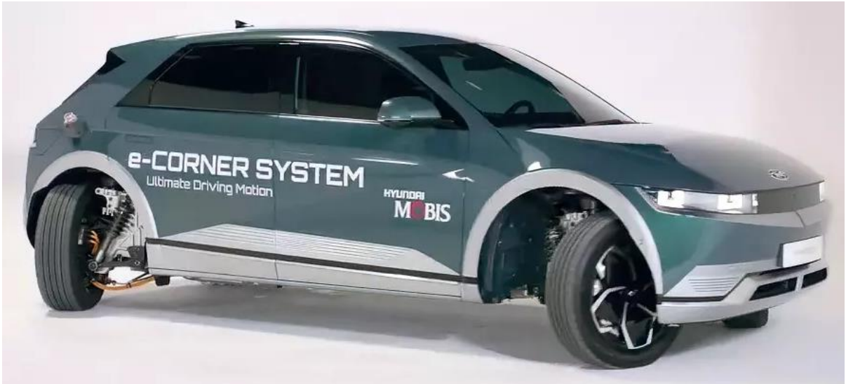
Рис. 1. Автомобиль с поворачиваемыми на 180° мотор- колесами (5).
