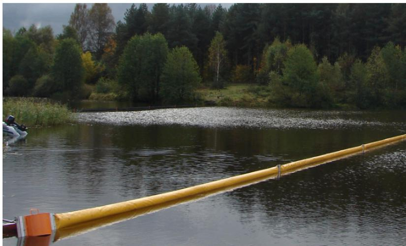
Боновые заграждения – это специализированные конструкции, применяемые в качестве стандартной практики для локализации или ограждения нефтяных разливов на твердой поверхности или в водах различных акваторий. Вариативность конструктивных решений позволяет расширить область применения бонов и позволяет применять некоторые их виды для безопасного перемещения нефтяных пятен, что обеспечивает повышенную безопасность объектам природы.
