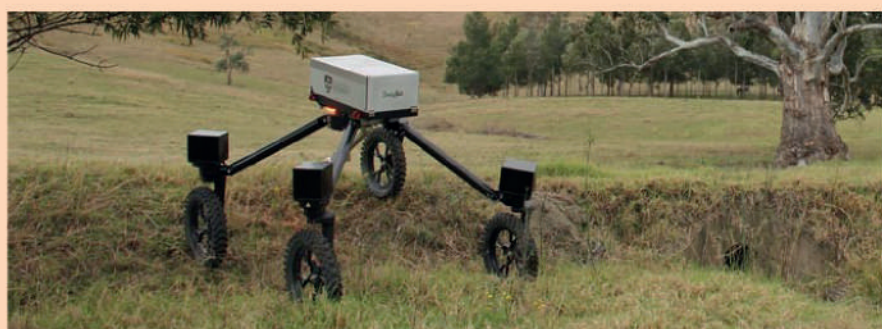
4. Пастух и пропольщик: робот двойного назначения SwagBot (Австралийский центр полевой робототехники)
