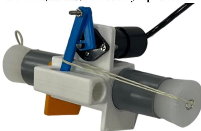
(рис. 4 – 1-ая версия батометра)
