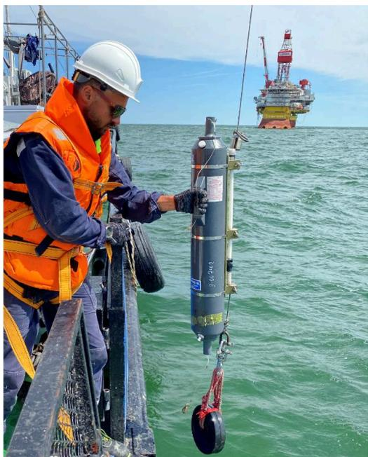
(рис. 2 –Отбор проб батометром Нискина)
