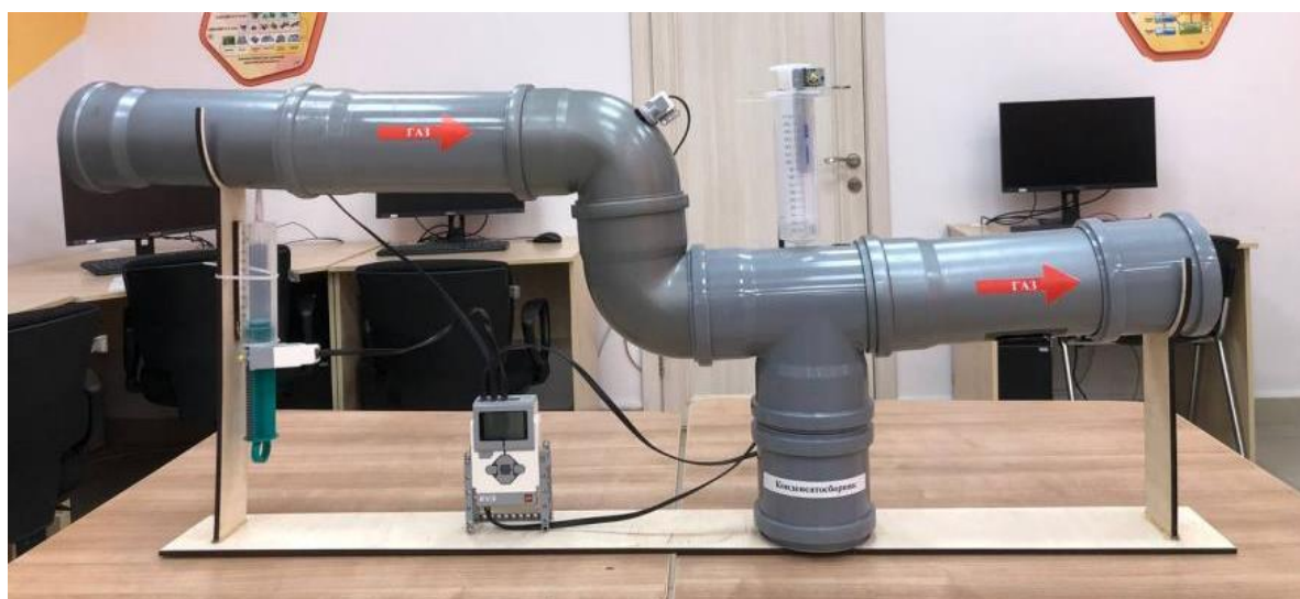
Фото 4 - Модель фрагмента межпоселкового газопровода, 3 вариант
