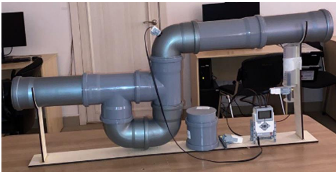
Фото 3 - Модель фрагмента автоматизированной системы с конденсатосборником, 2 вариант
