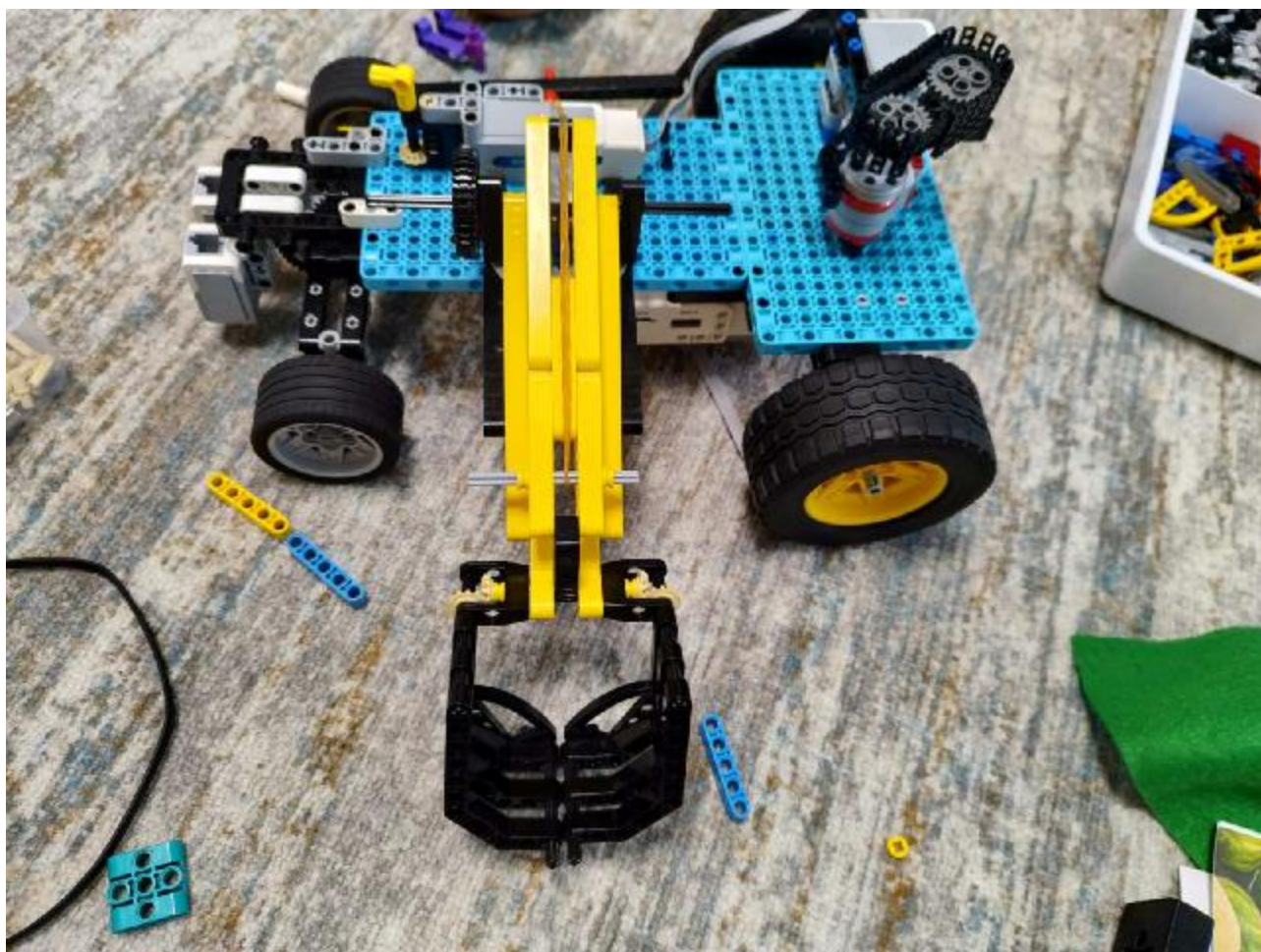
Рис. 10. Этап «желтый трактор». Добавлен «второй этаж» для расположения блока EV3, захват на основе рычага, сложно добиться точной работы захвата – в процессе копится ошибка позиционирования.
