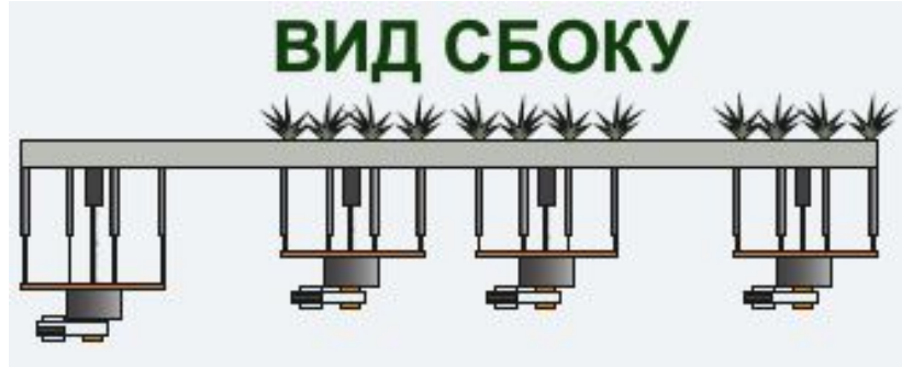
Фото. Механизм поднятия одной из 4-х частей поля.
