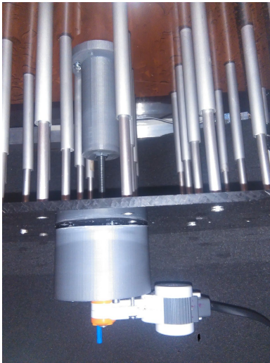
Фото. Механизм поднятия одной из 4-х частей поля.
