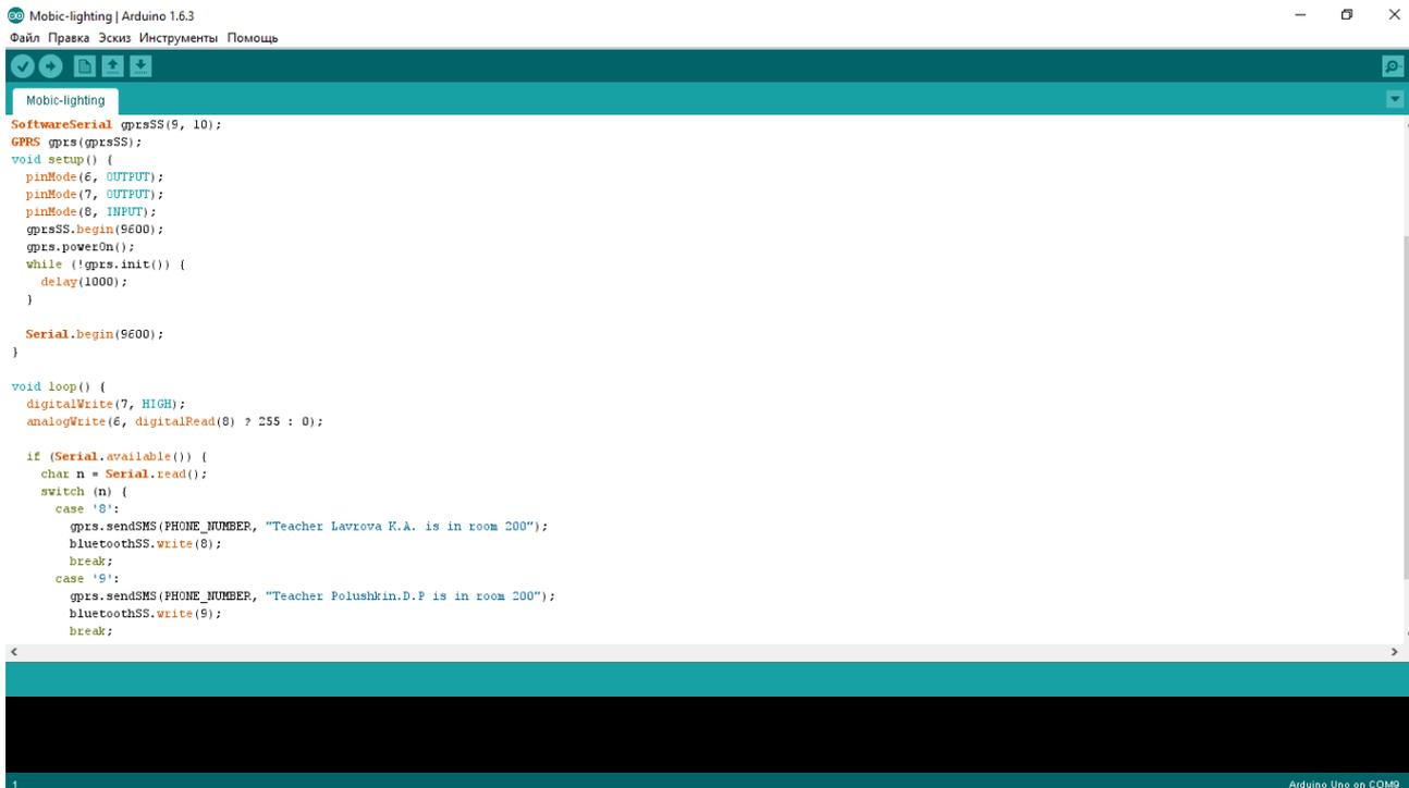
Далее эту же цифру система по Bluetooth отправляет блоку EV3, который в зависимости от цифры выдвигает нужные механизмы.
