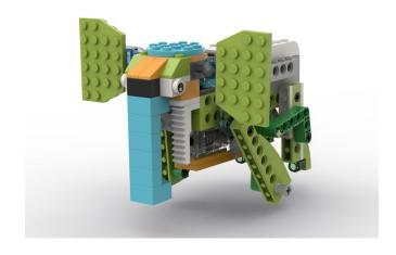
остальная часть является собственной разработкой. Робожирав реализован с помощью червячной передачи и кривошипно-шатунного механизма. За счет червячной передачи, движение робожирафа медленные и точные. Для реализации проекта были использованы: пластины, балки, оси, коннекторы, втулки, шкивы, кирпичики, кирпичики со срезом, шарнирные кирпичи, мотор, смарт-хаб, датчик расстояния, червячный механизм. Устойчивость модели обеспечивают 4 ноги, маленькая скорость и баланс веса робота.
