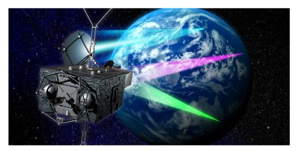
Преимущества лазерной передачи энергии заключается еще и в меньшей расходимости лазерного луча по сравнению с СВЧ-сигналом, поэтому он позволяет уменьшить площадь передающих и приемных систем.
