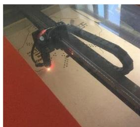
Резка фанеры на лазерном станке (рис. 12)
