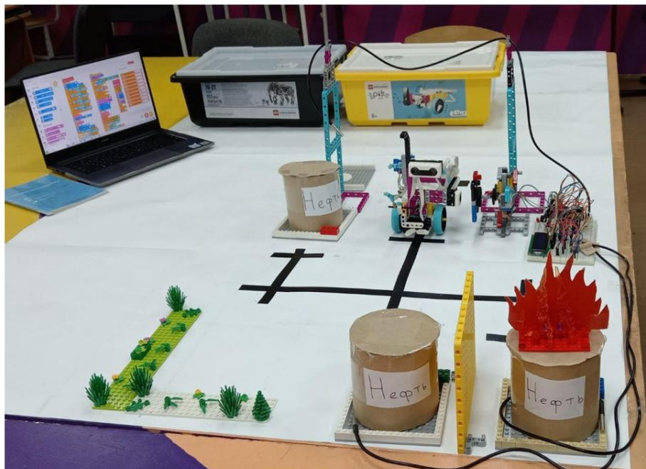
Данный проект основан на использовании конструктора «*Lego Spike Prime*» и электроники «*Arduino Uno*» и представляет собой инновационное решение для обеспечения безопасности на объектах хранения нефтепродуктов.
