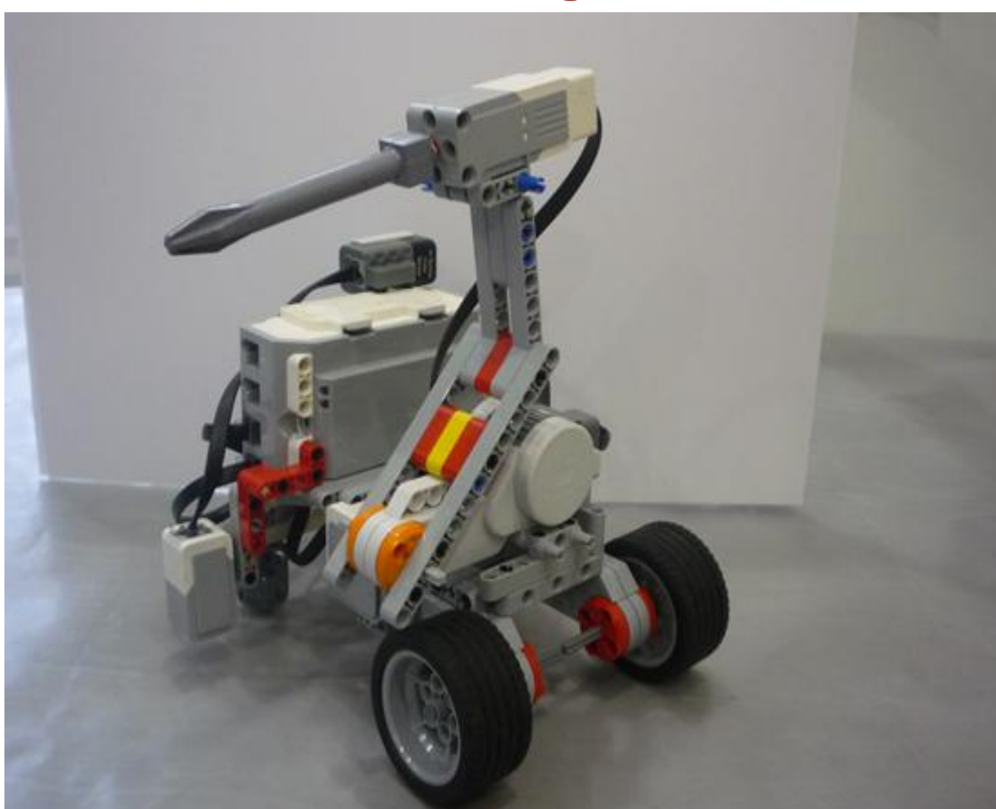
Устройство для создания лунок для посадки рассады. Устройство создано на базе EV3
