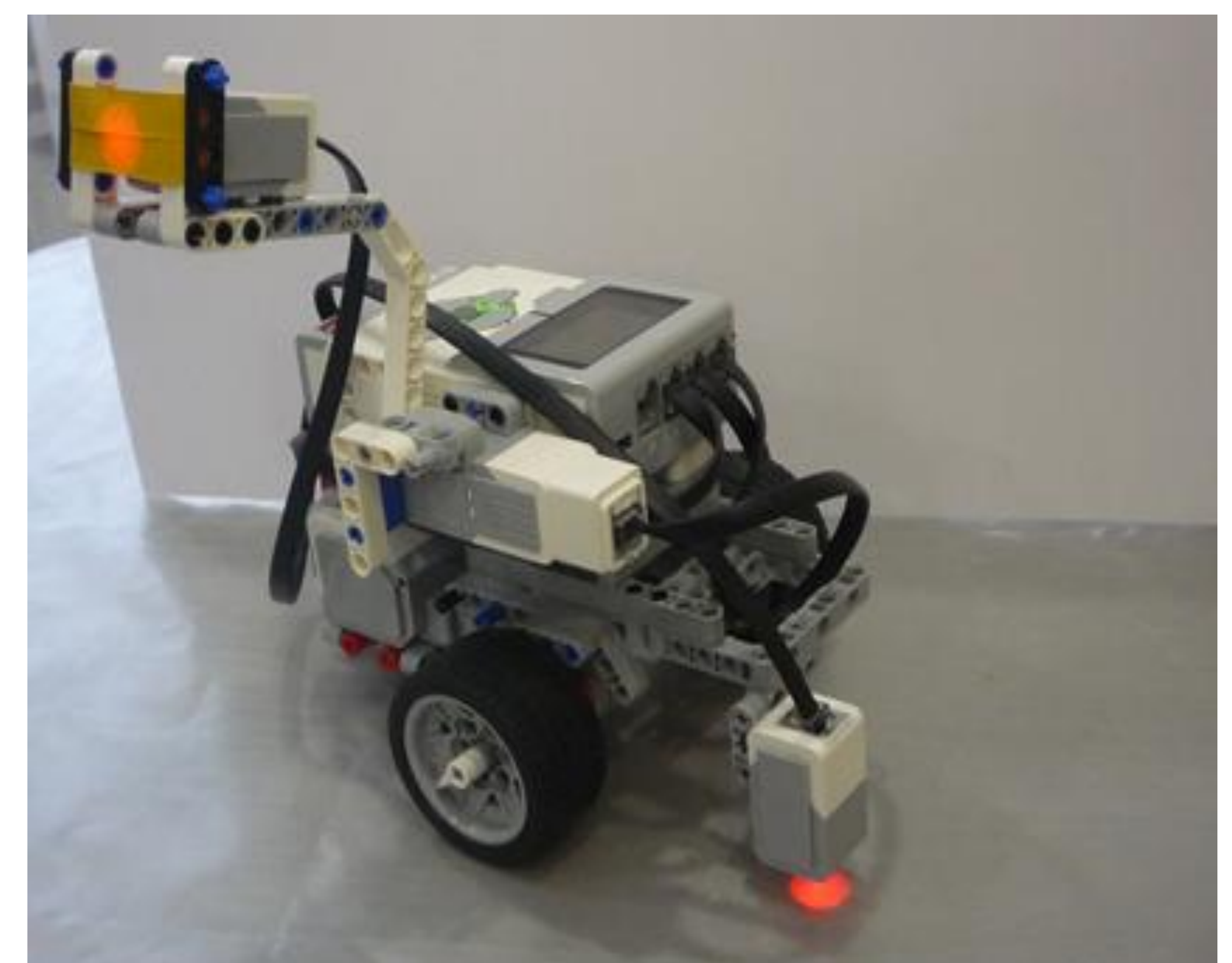
Устройство для определения кислотности почвы. Устройство создано на базе EV3
