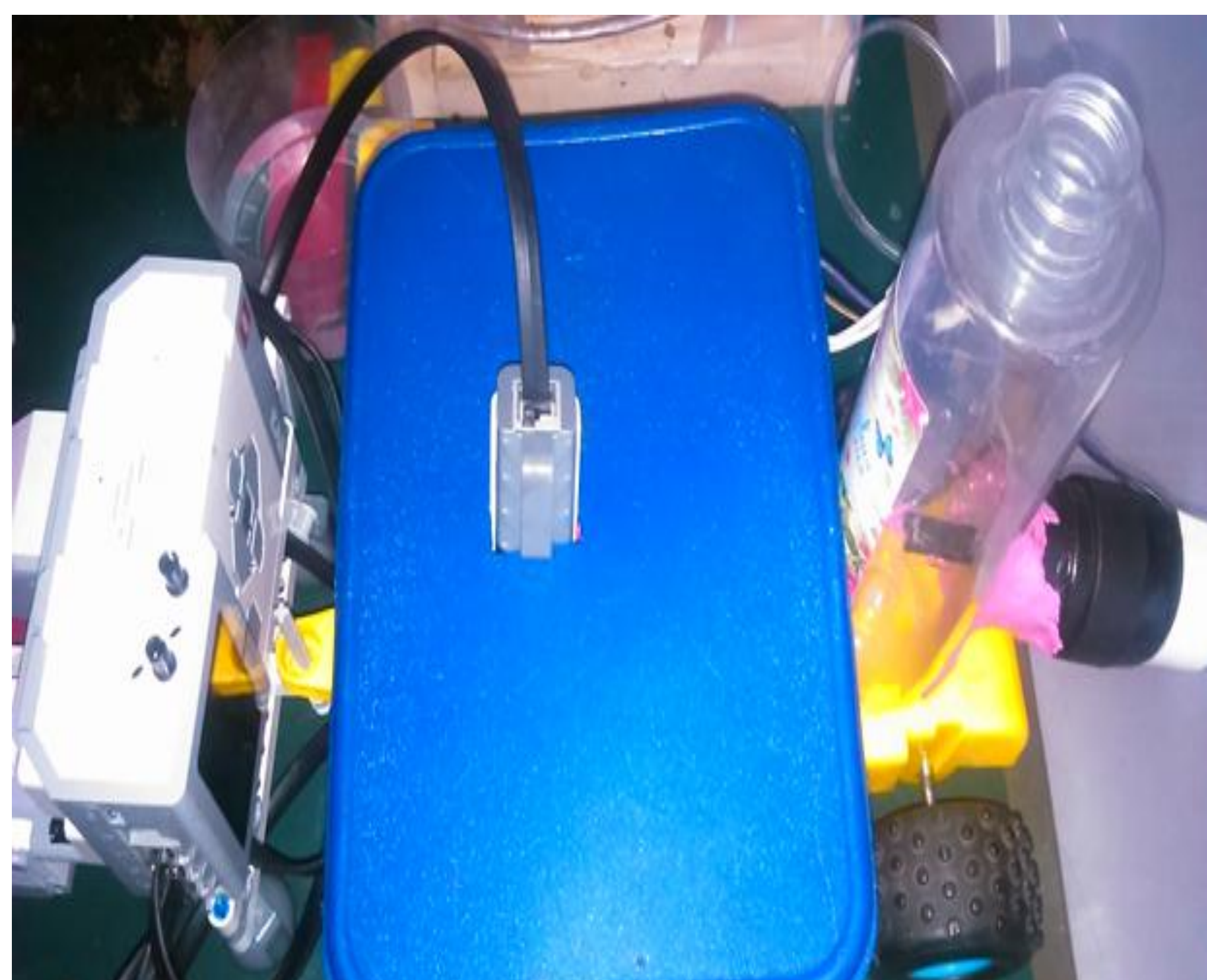
Устройство для полива и внесения удобрений. Устройство создано на базе EV3 и Arduino
