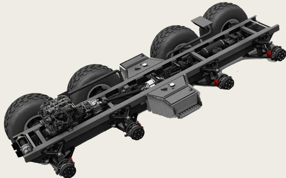
Тележка с четырьмя независимыми приводами
