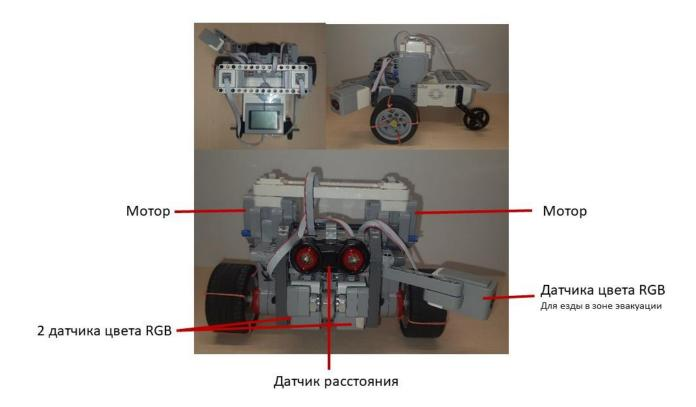
Робот построен на базе Lego MINDSTORMS EV3. В конструкции робота следующие элементы:
