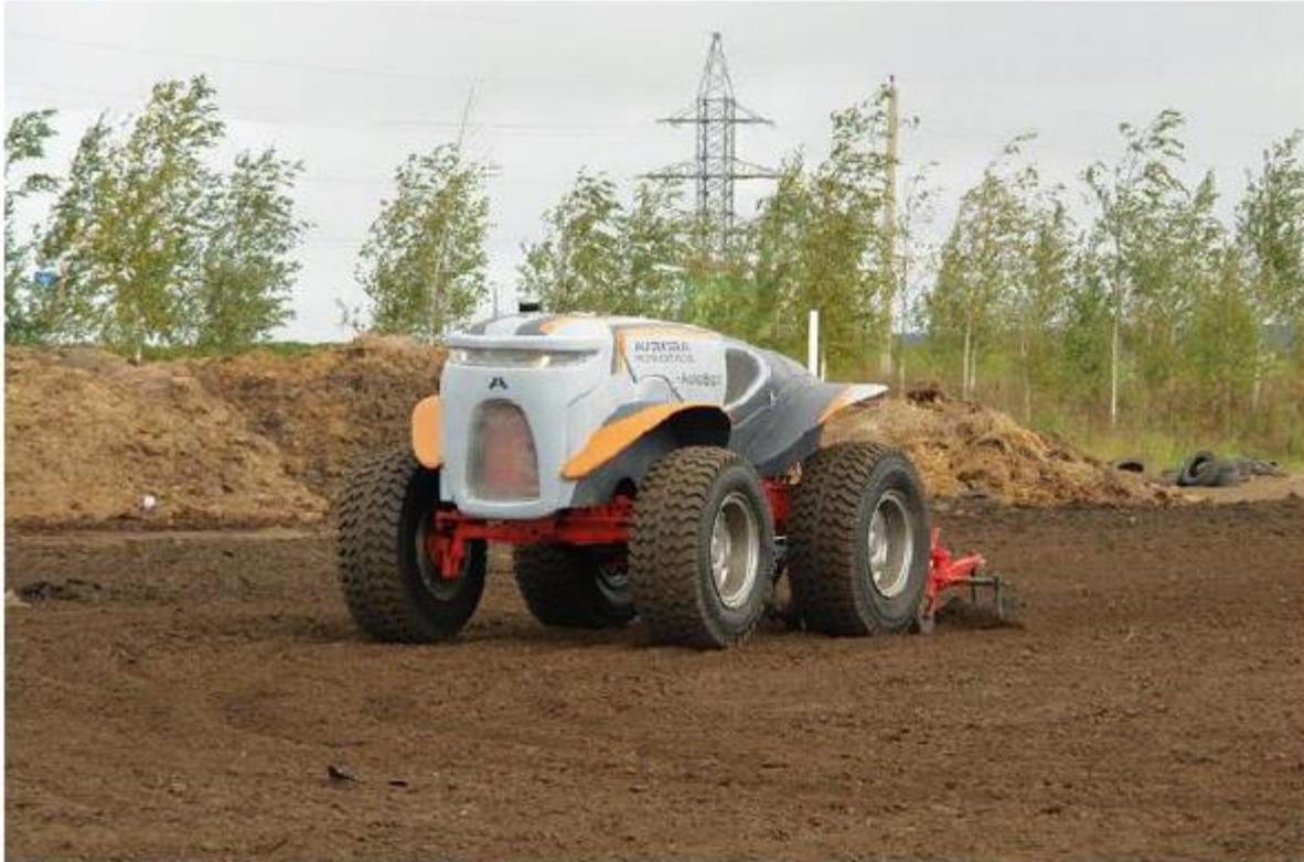
Колесный беспилотный роботрактор и одноименное решение - комплексная беспилотная система управления, состоящая из "комплекта автоматизации" трактора, диспетчерского центра и ряда вспомогательных систем. Решение может применяться для автоматизации работ в сельскохозяйственной или коммунальной сфере.
