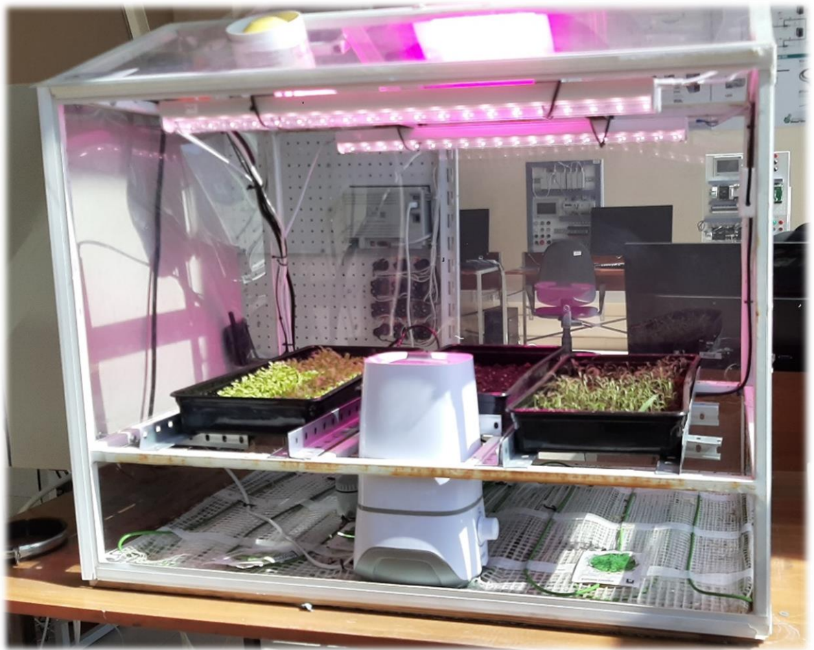
Макет лабораторной теплицы для изучения автоматизации микроклимата
