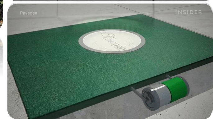
ПЬЕЗОЭЛЕМЕНТЫ ПОД БРУСЧАТКОЙ НА ОСТАНОВКАХ
