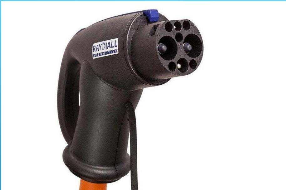
**GB/T** – Стандартом предусматриваются два типа разъемов: для медленной зарядки переменным током и для быстрой зарядки постоянным током.
